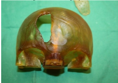
Slika 7. Segment lobanje i implantata izrađeni SLA metodom
