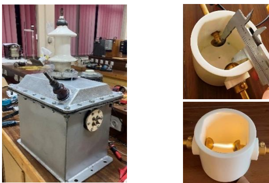
Слика 9. Приказ израђеног трансформатора и посуде за испитивање диелектричне чврстоће трансформаторског уља
