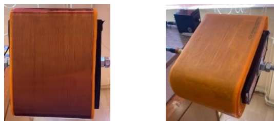
Слика 6. Приказ намотаја секундара: (а) слој од 480 навојака, (б) изолација намотаја
