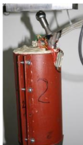
Slika 11. Ispitivanje modularne endoproteze pri statičkom opterećenju; eksperimentalni model EM1
