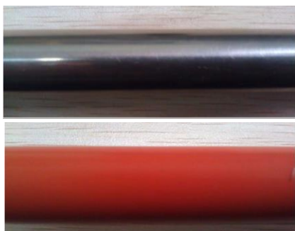
Slika 1. a) Provodnik bez RTV obloge; b) provodnik sa RTV materijalom nanešenim prskanjem [27]
