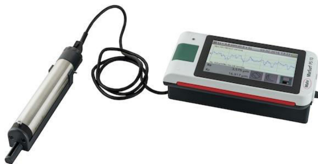
Slika 3. Izgled uređaja za merenje hrapavosti "MarSurf PS1"
