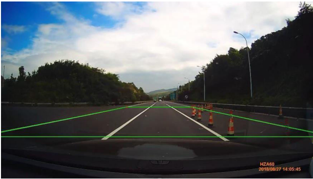
Slika 4. Ulazna slika na početku prvog koraka sa obeleženom regijom od interesa
