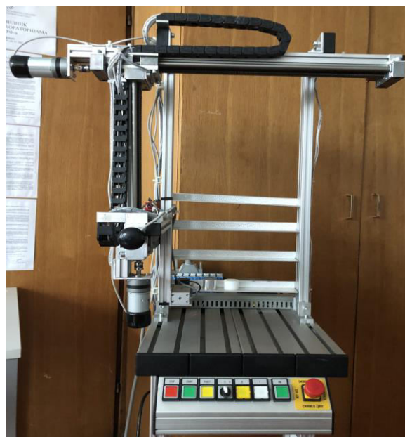
Slika 1. Izgled makete kartezijskog manipulatora
