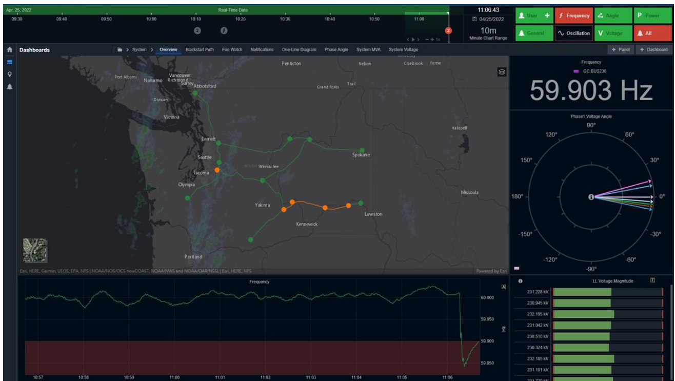
Slika 10. Izgled prednjeg panela komercijalnog WAMS-a u prenosnoj mreži
