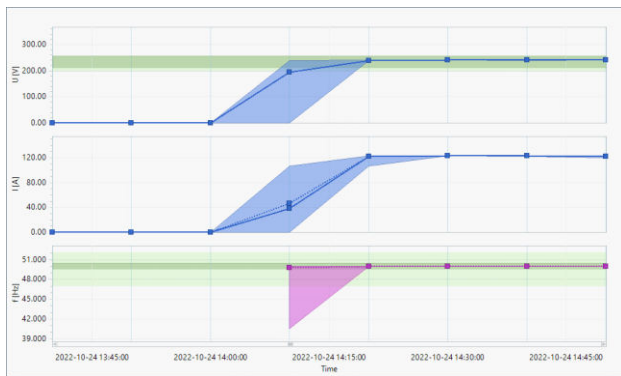
Слика 10 – Измјерене вриједности напона, струје и фреквенције ФНЕ Бранковићи 3 приликом укључења 10 kV далековода Пешурић
