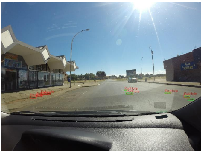
Slika 9. Prikaz rada modela – prepoznavanje rupa na trotoaru kao oštećenja na putu (na slici levo) i neprepoznavanje jednog objekta (na slici desno)
