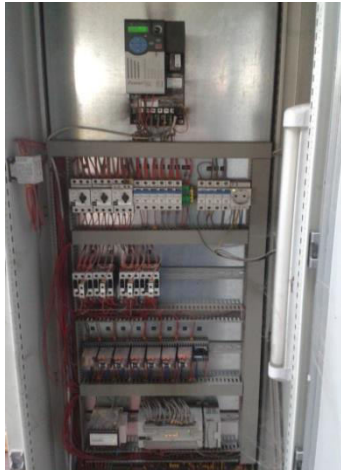
Slika 16. Izgled upravljačkog ormana odmotavača
