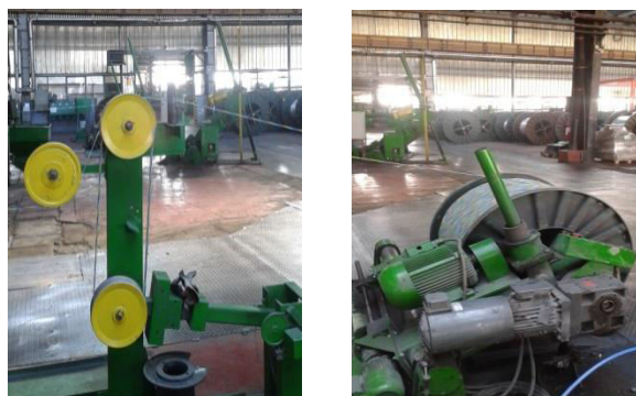
Slika 15. Danser i odmotavač u pogonu fabrike
