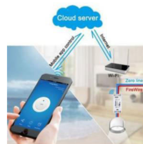
Slika 6. Princip upravljanja Sonoff WiFi uređajem preko eWeLink [2]
