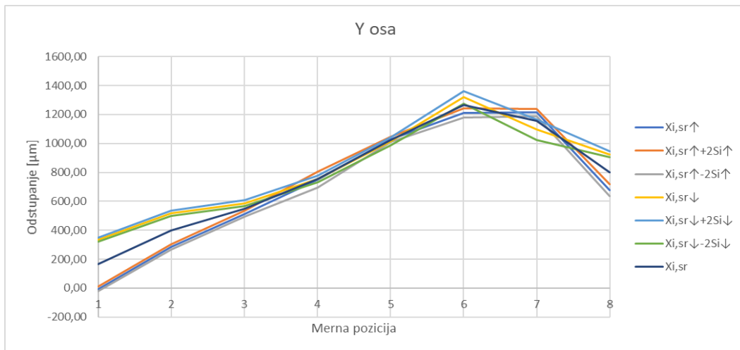
Slika 5. Grafički prikaz dobijenih podataka merenja tačnosti pozicioniranja Y ose prema ISO 230-2
