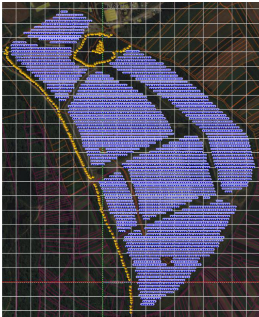
Slika 1. Prostorni izgled solarne elektrane instalisane snage 30 MWp u softverskom alatu PVsyst
