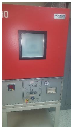
Slika 3. Senzori su u klima komori izlagani temperaturama iz opsega -20\text{ }^{\circ}\text{C} - +70\text{ }^{\circ}\text{C}
