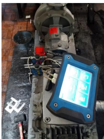
Slika 7. Primjena TKSA 31 pri centriranju vratila elektromotora i pumpe
