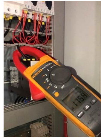
Slika 12. Polazna struja pri direktnom pokretanju motora
