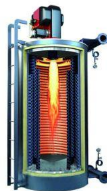
Slika 1. Presjek kotla termalnog ulja sa svim njegovim elementima
