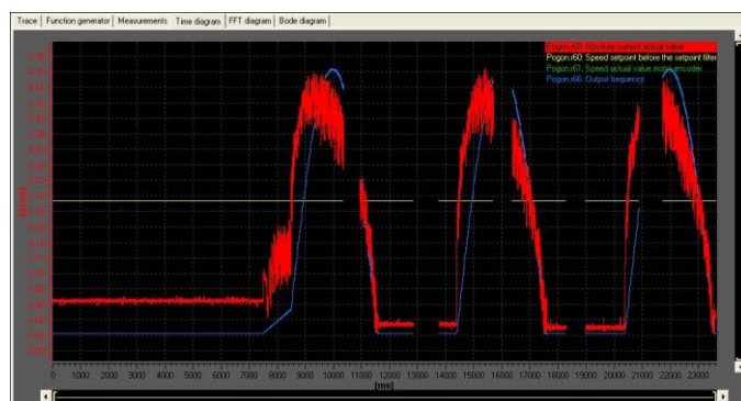
Слика 11. Временски дијаграм пуштања у рад СМСМ из Function generator-a
