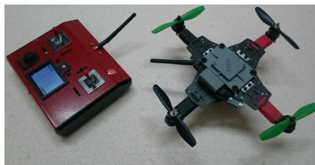
Slika 5. Razvojni sistem Oroz ( kvadrokopter )
