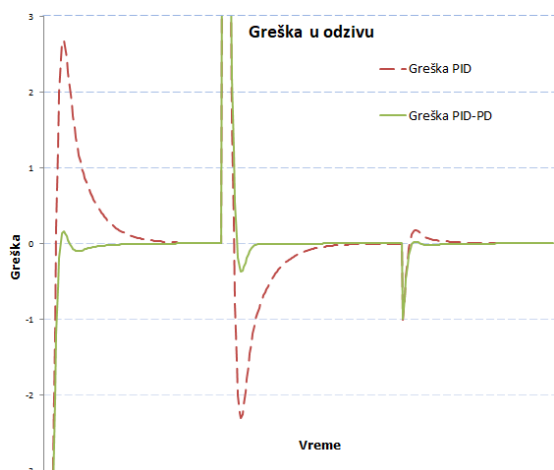
Slika 3. Greške u odzivu sistema sa PID ( crvenom linijom ) i PID u kombinaciji sa PD regulator ( zelenom linijom )
