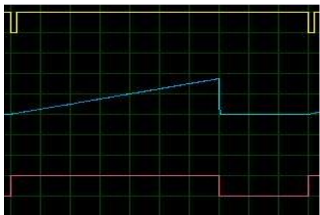
Slika 12. Talasni oblici pri simulaciji za faktor ispune 70%
