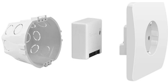
Slika 8. Ugradnja Sonoff mini WiFi prekidača u montažnu kutiju utičnice [7]
