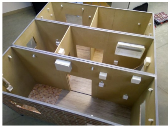
Slika 5. Izvođenje elektroenergetske instalacije - postavljanje elemenata instalacije (utičnica, prekidača, instalacionih vodova itd.) u modelu [1]
