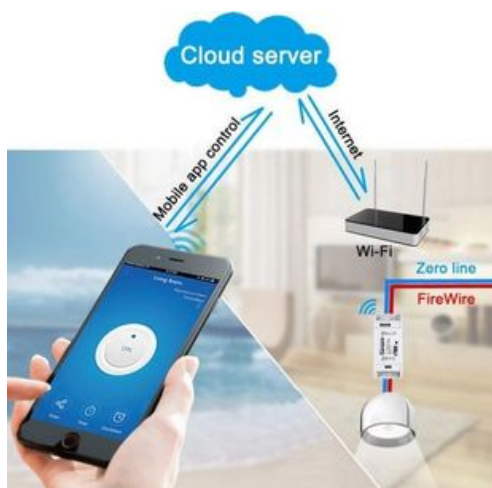
Slika 1. Princip upravljanja Sonoff WiFi uređajem preko eWeLink aplikacije instalirane na pametnom telefonu [1]
