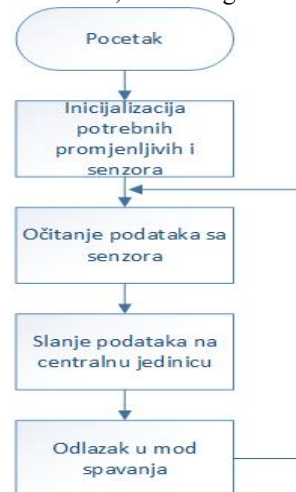
Slika 7. Blok dijagram senzora BH1750
