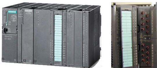
Slika 4. Izgled PLK uređaja iz SIMATIC S7-300 serije (lijevo) i izgled dodatnog modula Modul SM374 (desno).
