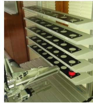
Slika 3. Magacin za skladištenje radnih predmeta na ASR stanici.
