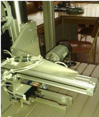
Slika 2. Pneumatska hvataljka kojom se prenose radni predmeti do mjesta za sortiranje.
