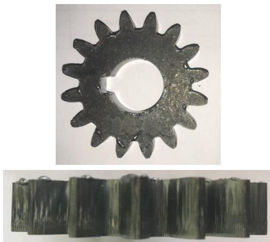
Slika 12. Izgled zupčanika dobijenih laserskim rezanjem
