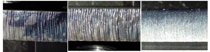
Nizak Srednji Visok Slika 10. Kvalitet obrađenih površina dobijenih pri obradi laserom
