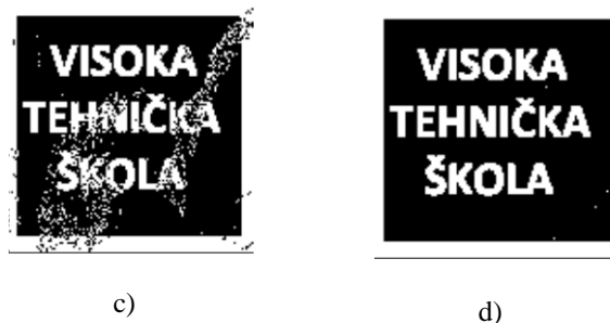
Slika 7. Izgled inverznog žiga: a) originalni žig, b) ekstrakovan iz slike sa \mu = 0.5 (pri T = 0.01 ), c) ekstrakovan iz slike sa \mu = 0.25 (pri T = 0.01 ), d) ekstrakovan iz slike sa \mu = 0.75 (pri T = 0.01 ).
