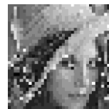
Slika 4. Ekstrahovan i popravljen vodeni žig iz dekodovanog videa primenom CB-SVD algoritma, SSIM = 0.9127.
