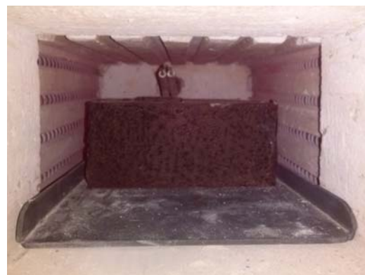
a) unutrašnjost hladne peći sa šaržom
