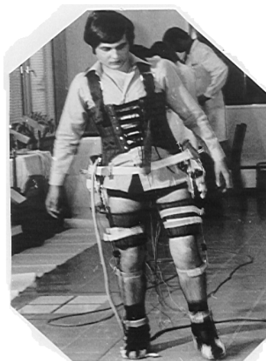
Slika 5. “Aktivno odelo” (meko odelo) je bio modularni polu-aktivni uređaj namenjen distrofičarima. Napravljen je 1978. godine. Imao je elektromotorni pogon i savremeno mikroprocesorsko upravljanje. Prodat je Rehabilitacionom centru u Hjustonu, Teksas, USA sa ciljem daljeg razvoja i unapređenja.
