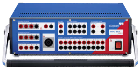
Slika 5. Ispitni uređaj CMC 256 kompanije Omicron
