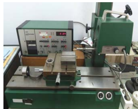
Slika 3. Uređaj za mjerenje hrapavosti (Perthometer S5P Perthen)
