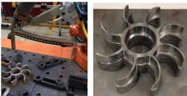
Slika 1. Izrada WAAM komada i djelomično strojno obrađeni komad [6]
