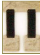
Slika 1. Fotografija debeloslojnih otpornika slojne otpornosti 10 kΩ/□ upotrebljenih u eksperimentalnom istraživanju
