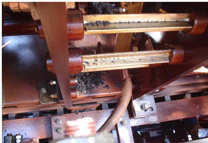
Slika 4. Izgled kvara regulacione sklopke
