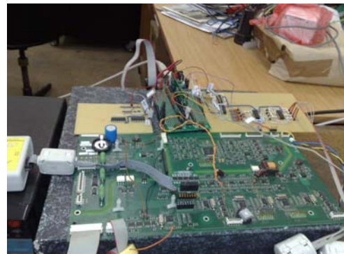
Slika 10. Upravljačka kola primarnog (master) i sekundarnog (slave) invertora
