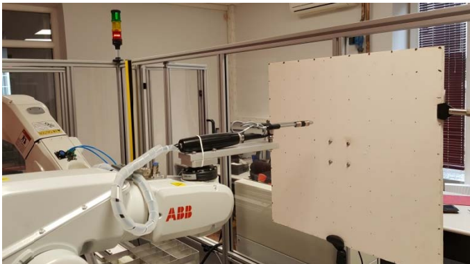
Slika 4. Postavka eksperimenta: Robot sa intenzitetskom sondom i DML zvučnik
