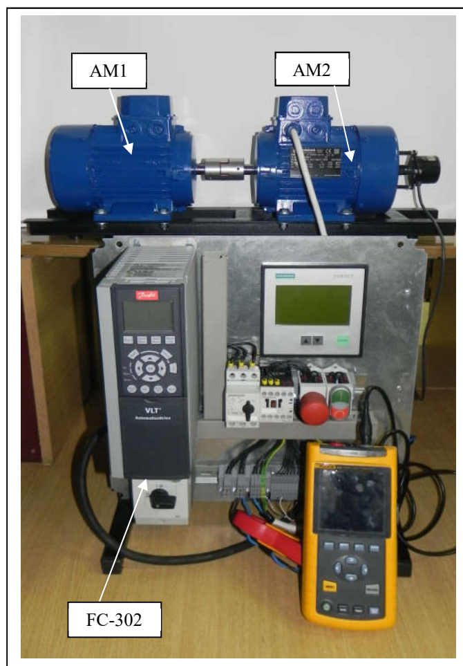
Slika 4. Eksperimentalna postavka sa dve asinhronne mašine
