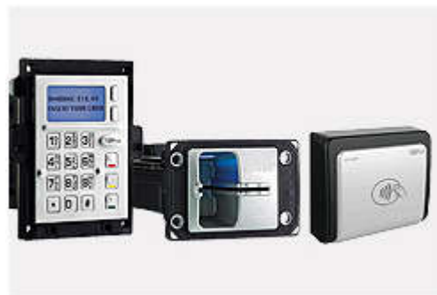
Slika 6. Uređaji za kontaktno i bezkontaktno očitavanje platnih kartica sa unosom ličnog identifikacionog broja (PIN) [17]
