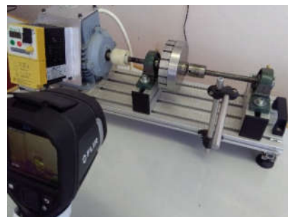
Slika 9. Opterećenje vratila masom od 1391 g
