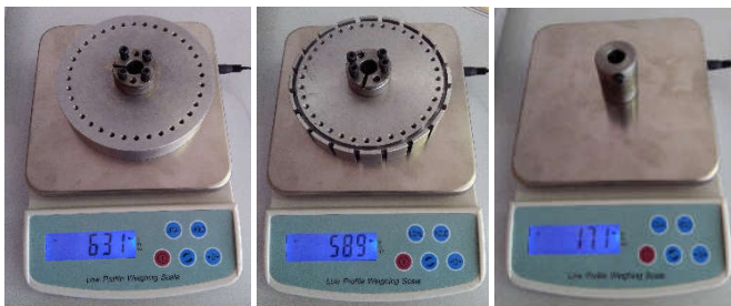
Slika 5. Izmjerene mase diska na preciznoj vagi
