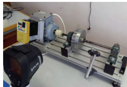
Slika 8. Opterećenje vratila masom od 1220 g
