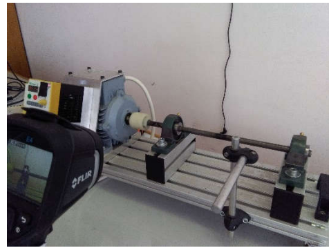
Slika 6. Mjerenje temperature na neopterećenom ležaju
