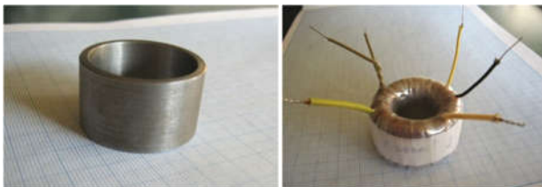
Slika 5. Torusno jezgro od ispitivanog materijala i namotan naponski transformator
