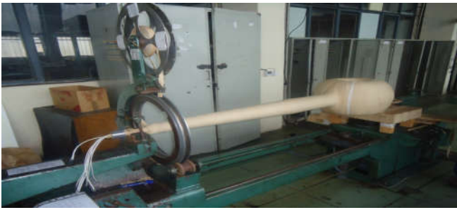
Slika 2. Izolovani aktivni dio IST 123-2 mjernog strujnog transformatora [4]
