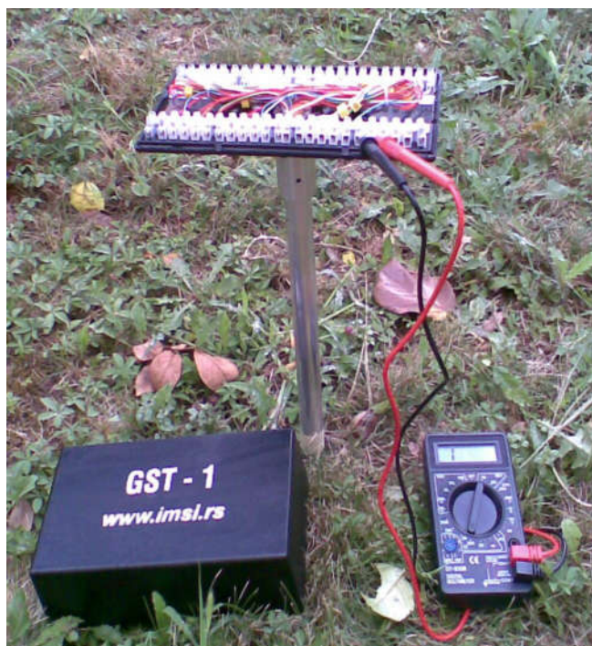
Slika 6. Testiranje gradijentnog senzora temperature tla
