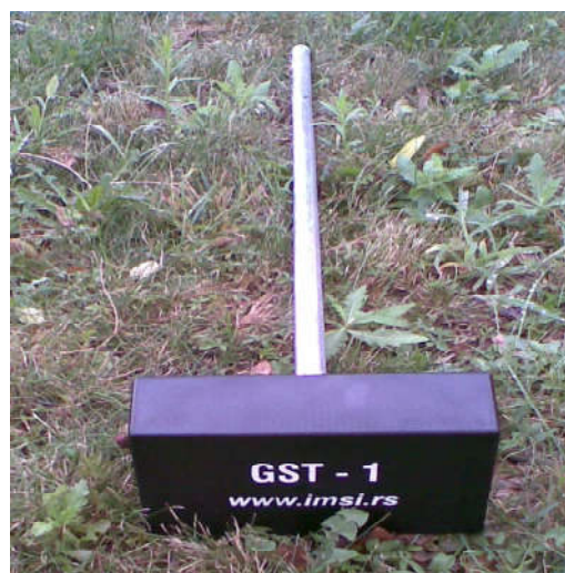
Slika 4. Gradijentni senzor temperature tla
