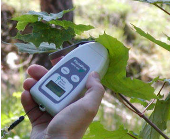
Slika 4. Primer uređaja za merenje indeksa refleksije biljaka
