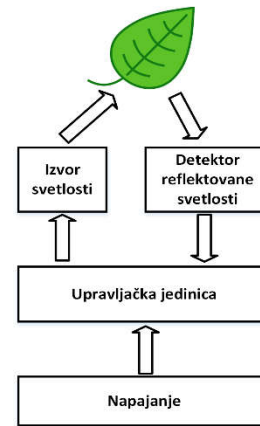
Slika 5. Blok šema predloženog rešenja
