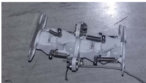
Slika 4. Eksperimentalni dvosegmentni mehanizam sa po 2 stepena slobode kretanja (rotacija oko x i y ose)
