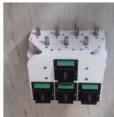
Slika 10. 3D štampani model pogonske kutije IMP Snake robota sa ugrađenim motorima i drajverima
