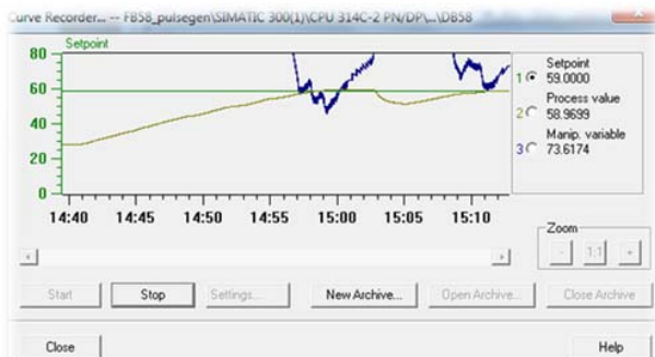
Slika 9 Dostizanje zadate vrijednosti i reagovanje sistema na poremećaj (dolivanje 2l hladne vode)
