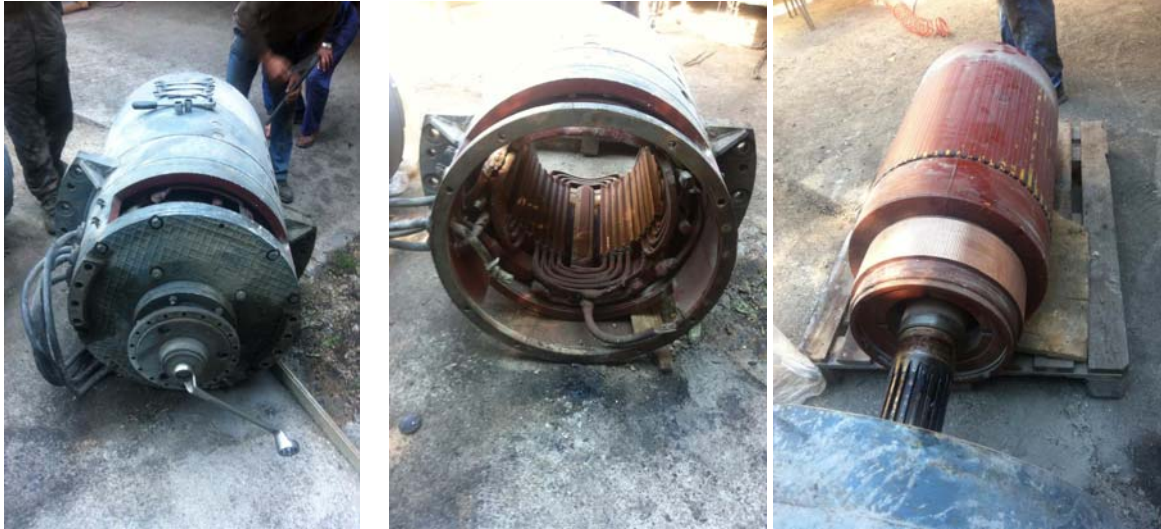
Slika 1. Remontovani jednosmjerni motor snage 420 kW
