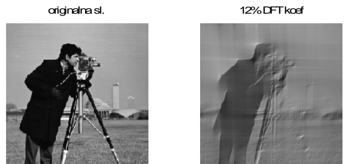
Slika 1. Originalna (nekompresovana) slika i slika rekonstruisana na osnovu 12% od ukupnog broja DFT koeficijenata
