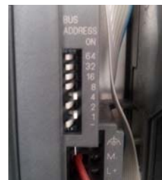
Slika 7. Ručno podešavanje profibus adrese 6 kod ET 200M kao slave uređaja sa DIP prekidačima
