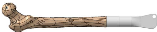
Slika 3. Računarski model butne kosti sa implementiranom protezom
