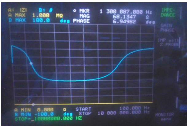
Slika 3. Frekvencijska karakteristika snimljena pomoću analizatora impedanse (4194A)
