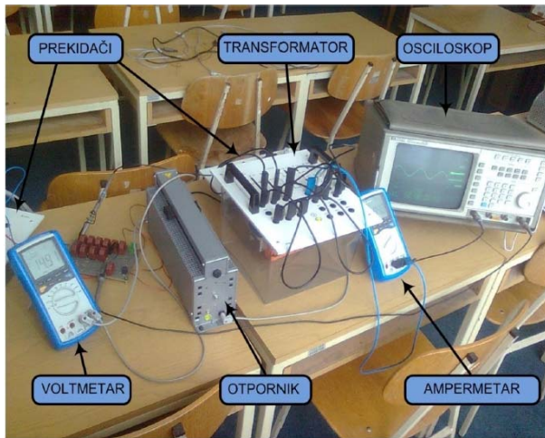
Slika 3. Mjerna šema za analizu fizičkog modela nadzemnog voda
