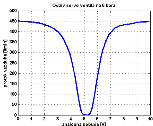
Slika 2. Prenosna karakteristika servo ventila tipa MPYE
